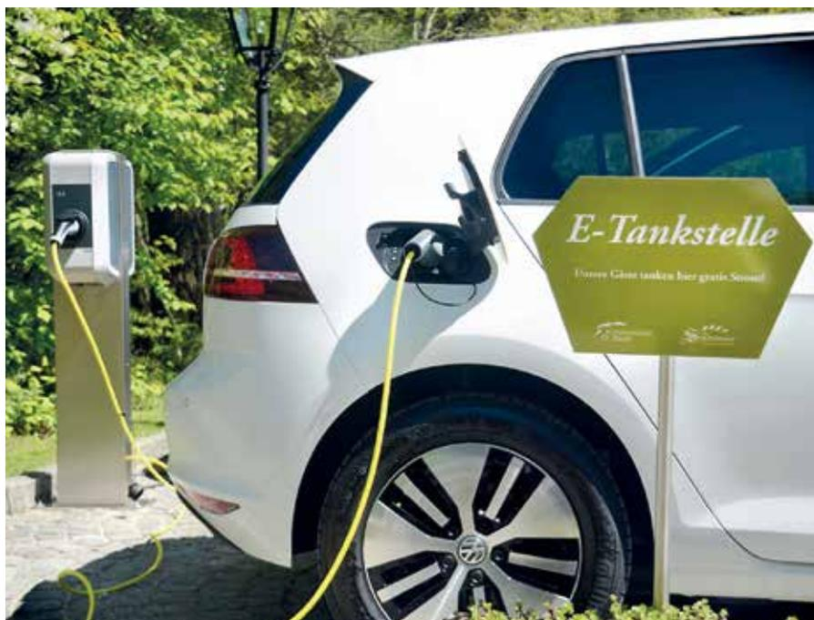
Zur Verfügung stehen zwei Ladestationen mit einer Leistung von je 11 kW, welche mit einer Ladebuchse des Typs 2 ausgestattet sind. Der Gast steckt sein Ladekabel an der Station sowie am Auto an und startet den Ladevorgang mittels einer Karte, die er beim Servicepersonal des Schützenwirts oder an der Kasse des Kulturzentrums
